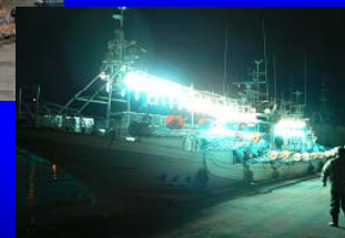
イカ釣り漁船濱出丸(19トン)を用いた調査 周年にわたる実証実験を行うことで、様々な海域・時期に適 合したLED漁灯の操法を確立
