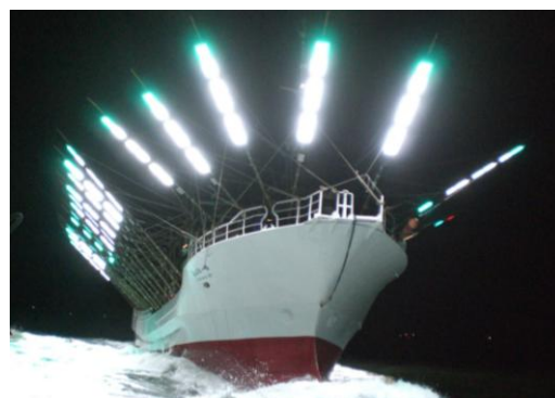
図 2. 世界初 LED 漁灯全装サンマ棒受網漁船「第 1 太喜丸 (133 トン，長崎県雲仙市船籍)」
