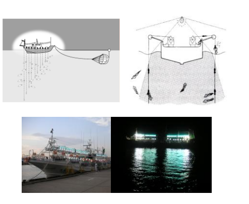
図4. イカ釣り操業模式図とLED漁灯装備の19ト船
